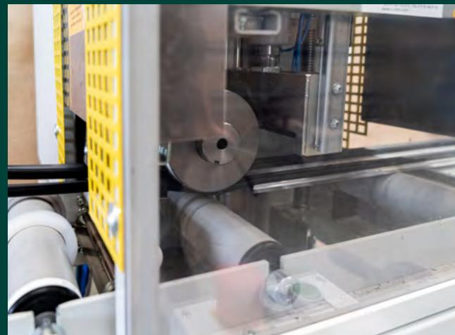
**Konstante Qualität:** Maschinelles Einziehen der Dichtung gewährleistet höhere Präzision und gleichbleibende Qualität im Vergleich zur manuellen Verarbeitung.
