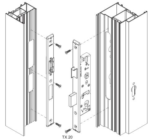
Ins Profil einschieben und mit Schrauben 908016 befestigen.
