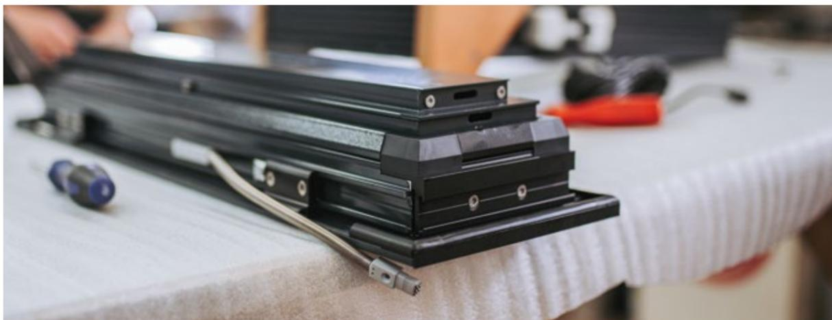
FRAME<sup>+</sup> 75 LF est un battant pivotant d'une largeur de 170 mm ou 300 mm qui s'intègre parfaitement dans la gamme de fenêtres et de façades RAICO. La coque extérieure « découpée » permet de réduire l'effet bimétallique. Pour l'ouverture motorisée, il existe une unité d'actionnement de battant pivotant entièrement invisible, sans chaîne apparente.
